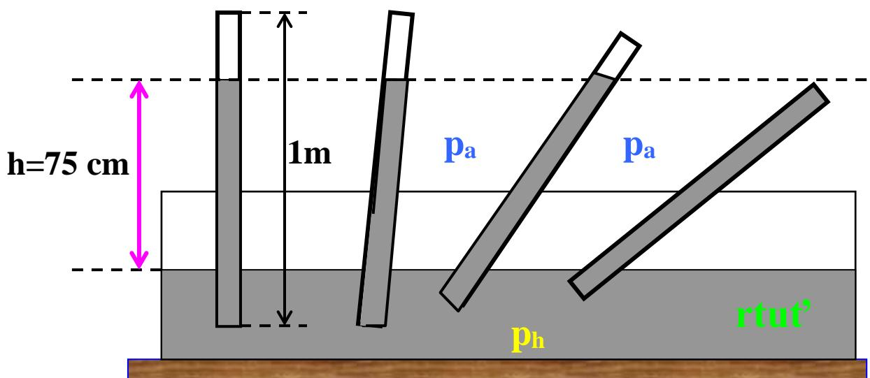
Atmosférický tlak určíme pomocí hydrostatického tlaku rtuti :
